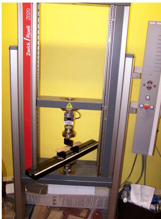
Figure 4.11 : Banc d'essais de flexion sur la presse d'essais universelle Zwick.
