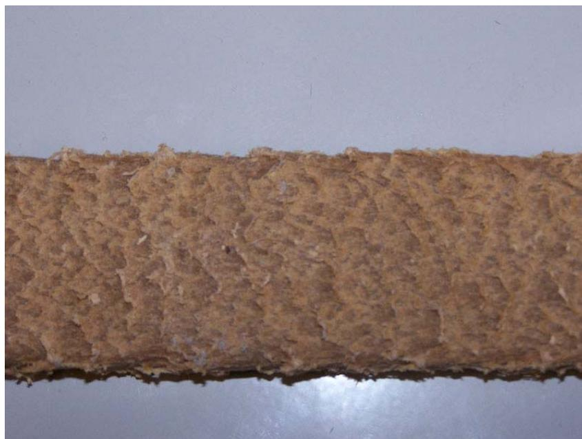
Figure 4.10 : Exemple de peau de requin sur un CPB extrudé dans les laboratoires de Washington State University.
