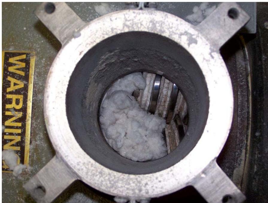
Figure 4.5 : Mélange contenant 60% de fibres Kraft et 40% de HDPE entrant dans la zone d'alimentation de l'extrudeuse Cincinati Milacron 45 mm.
