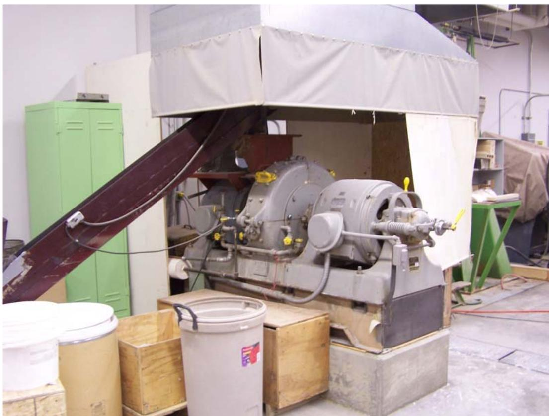
Figure 4.4 : Broyeur à disque contre rotatif du laboratoire de Washington State University.
